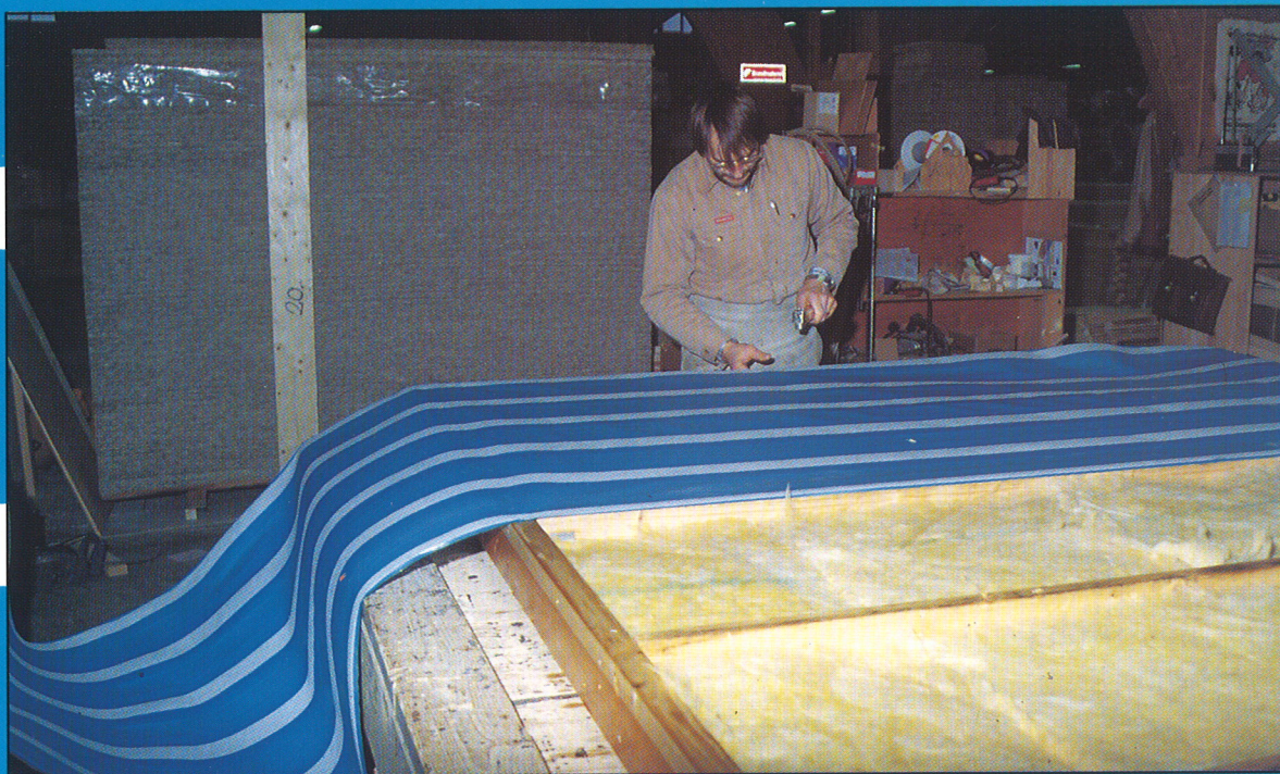
Fabriksfremstilling af uventilerede lukkede træ-tagkassetter med Hygrodiode dampbremse. Factory production of unventilated cold-deck roof cassette with Hygrodiode vapour retarder.
