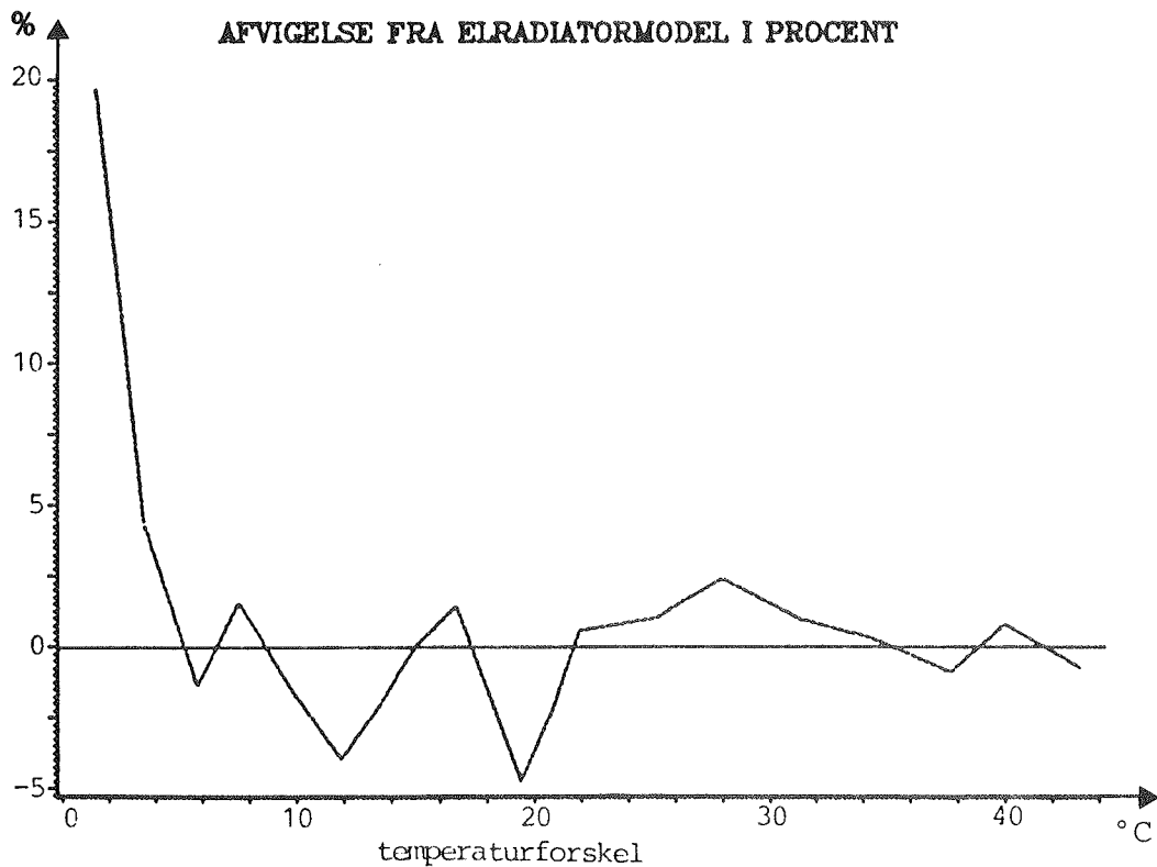
Fig. 8. De målte værdiers procentiske afvigelse fra regressionslinien. El-radiator, effektafgivelse, residual = 485,3.
