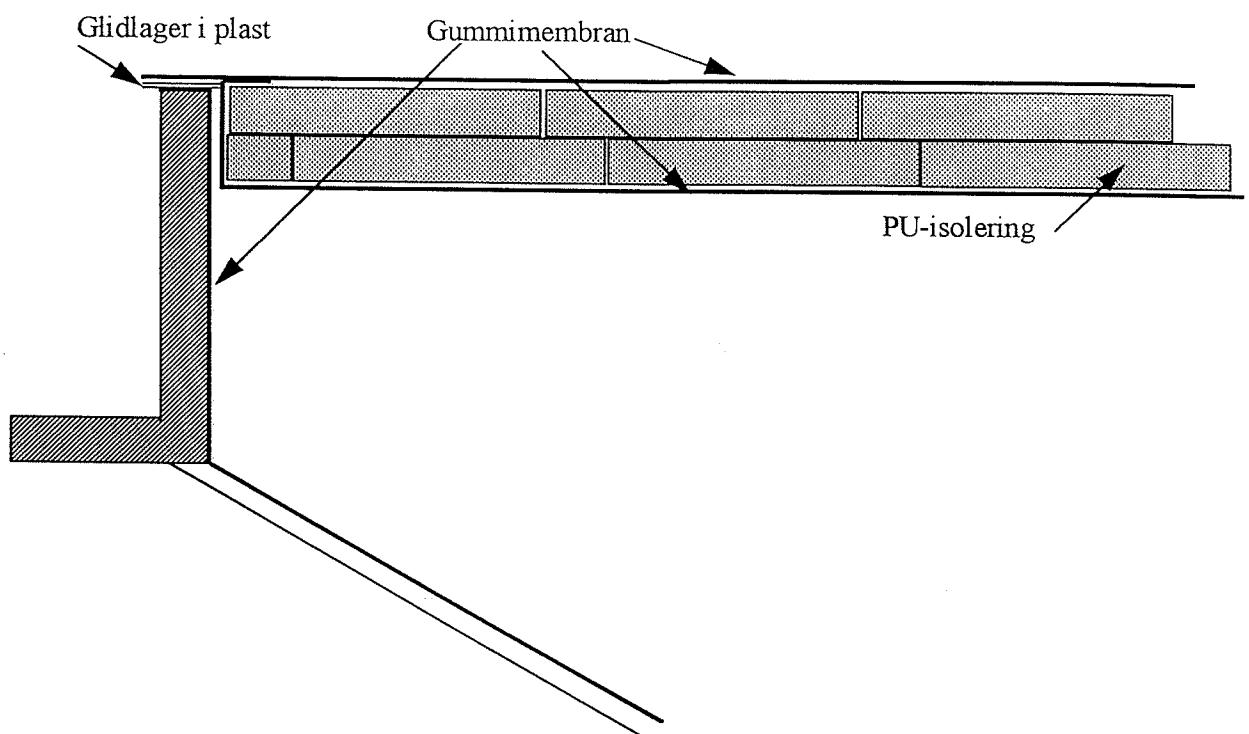
Figur 2.2: Principskiss över lockkonstruktion av värmelagret i Studsvik
