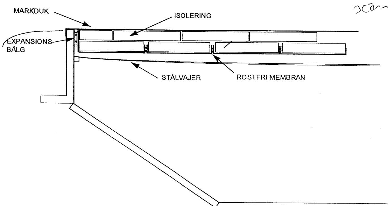
Figur 4.1: Flytande lock baserad på rostfri membran och PU-block isolering.
