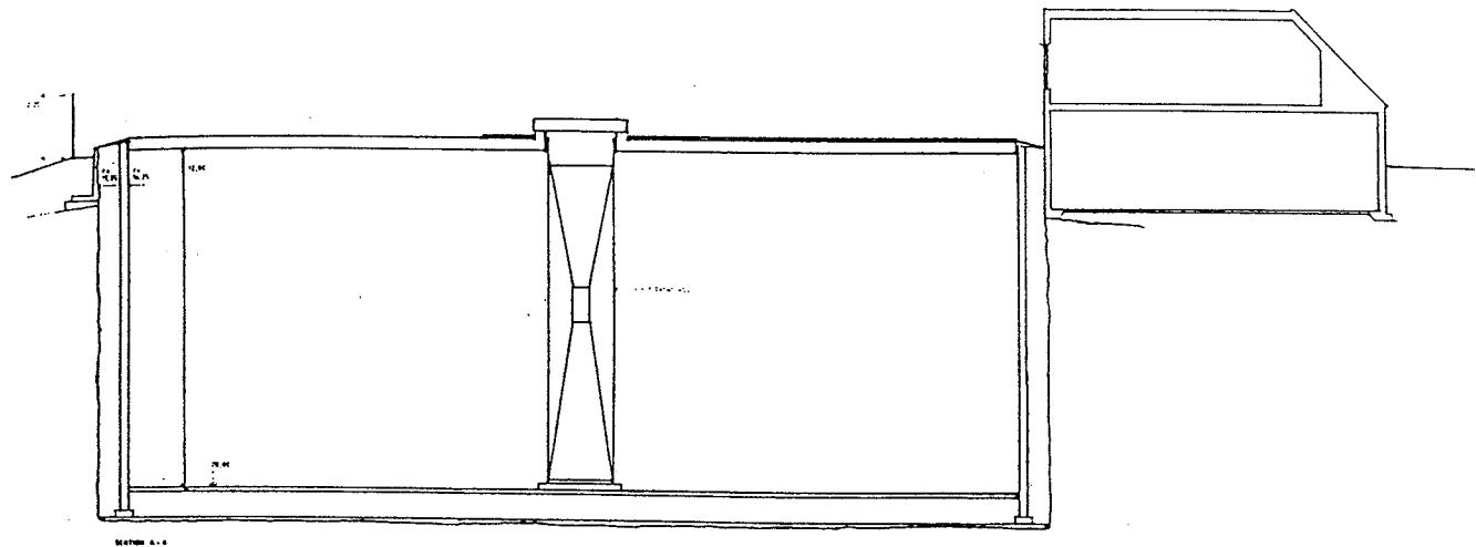
Figur 3.1: Tvärsnitt lager Lambohov: Botten, sidovägg lock och inspekionslucka.
