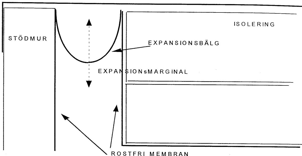
Figur 4.2 Detalj ur randtätnings av värmelagrets lock
