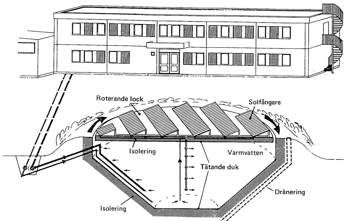
Figur 2.1: Principskiss av solvärmecentralen i Studsvik
