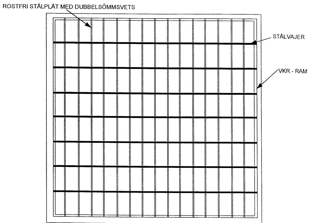
Figur 4.3 Locket på gropmagasinet sett nerifrån med sömsvetsar och stålvajer
