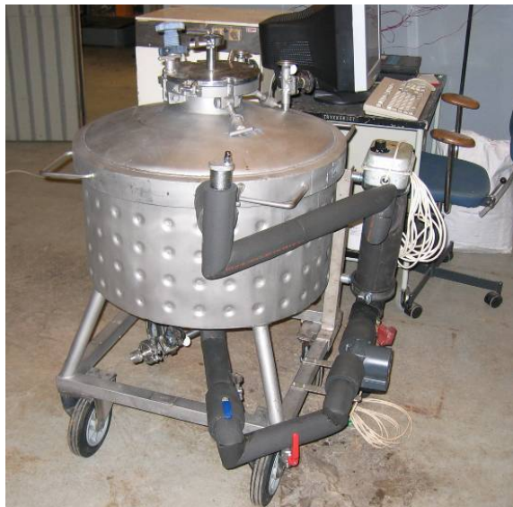
Figur 9. Venstre: Smeltebeholder med monteret varmelegeme til opvarmning af kappen. Højre: Smeltebeholder isoleret og monteret med slangepumpe (gul) til cirkulation af smeltet salthydration.
