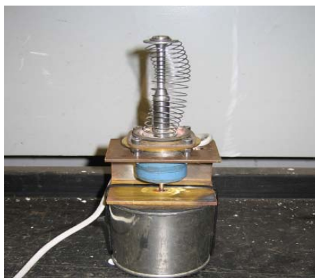
Figur 18. Opstilling til afprøvning af magnetdrevet stempel til aktivering af krystaldannelsen i et underafkølet salthydrat.
