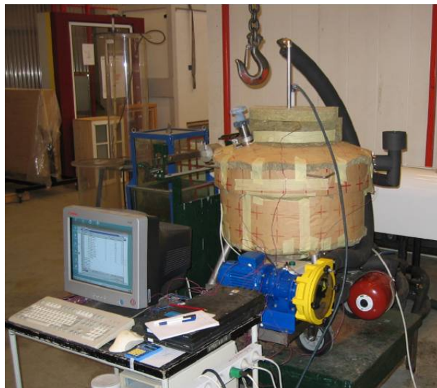
Figur 9. Venstre: Smeltebeholder med monteret varmelegeme til opvarmning af kappen. Højre: Smeltebeholder isoleret og monteret med slangepumpe (gul) til cirkulation af smeltet salthydration.
