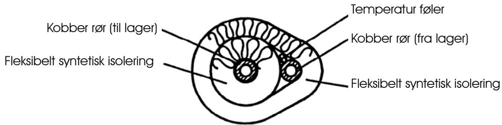
**Figur 3-2: Principskitse af en Flextube® solfangerkreds.**
