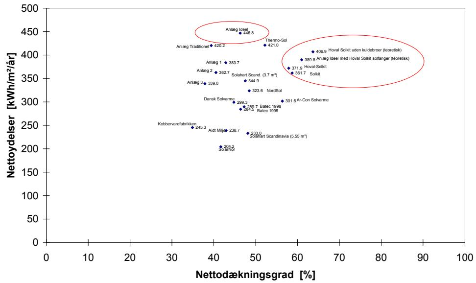
Figur 5-4: Årlige nettoydelser pr. m<sup>2</sup> solfanger, som funktion af nettodækningsgraden, for de afprøvede anlæg.
