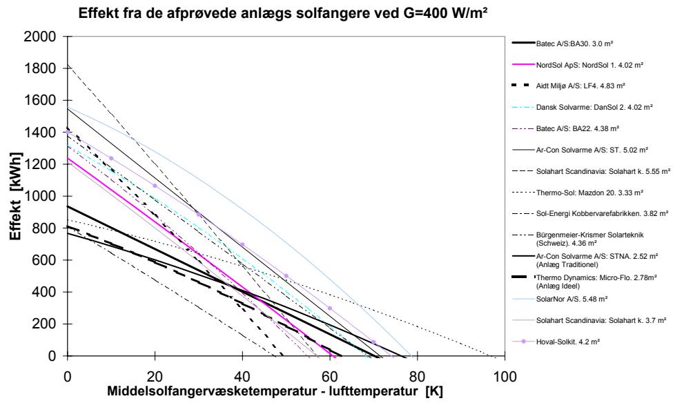
Figur 5-3: Effekt fra de afprøvede anlægs solfangere, ved en bestrålungsstyrke på 400 W/m<sup>2</sup>, som funktion af forskellen mellem middelsolfangervæsketemperaturen og lufttemperaturen.
