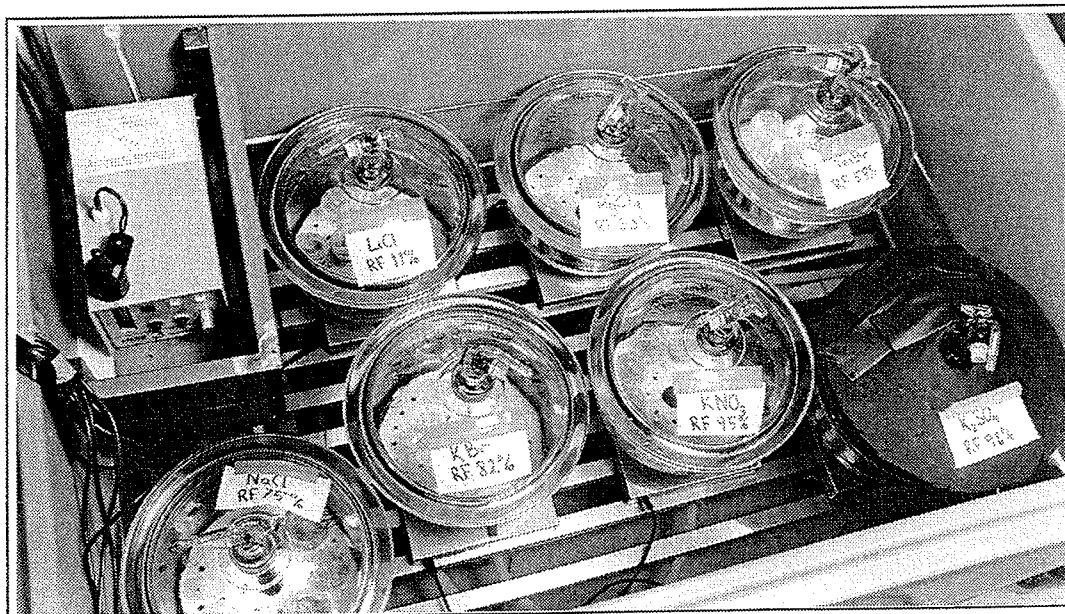
Figur 2. Termostatstyret vandbad med eksikkatorer, hvor temperaturen kan reguleres med en nøjagtighed på \pm 0,1^\circ\text{C} .
