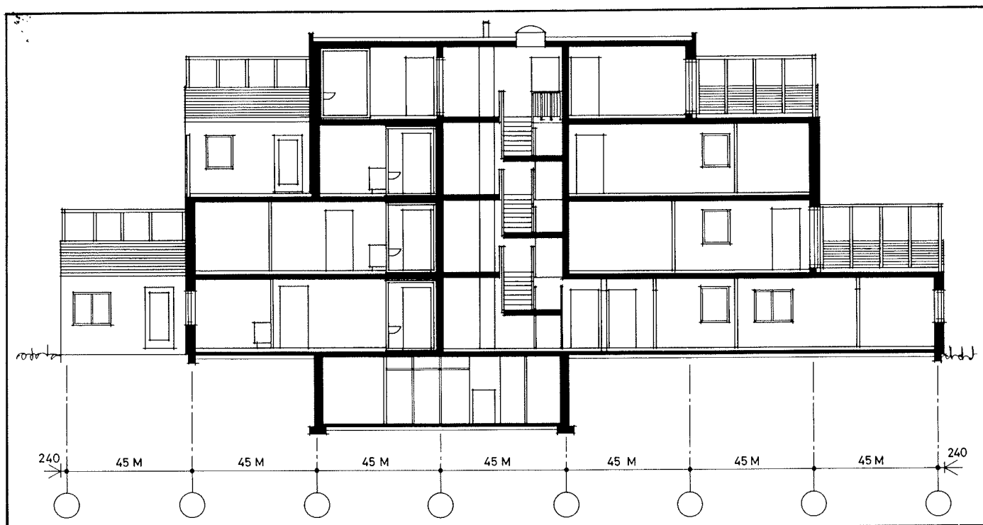
Figur 6. Tværsnit i blok fra VIBO-Niverød, 1:200. De bærende vægge afleverer deres last til søjlerne og behøver derfor ikke at være gennemgående fra top til bund i bygningen.
