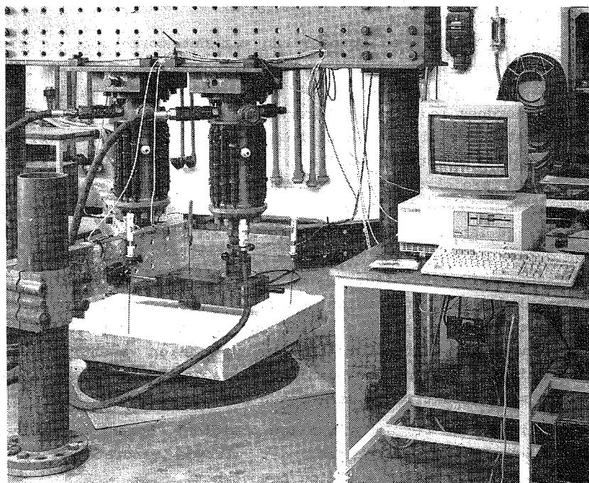
Forsøgsopstilling til gennemlokningsforsøg med alkalikiselskadede betonplader.
